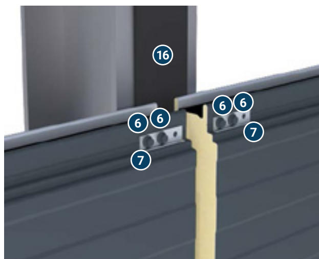
Colț - Stâlpi structurali
